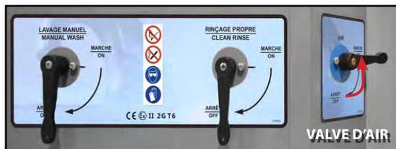
La Valve "Air" doit être en position MARCHÉ lors de l'utilisation de la laveuse. Celle-ci permet d'activer le système d'évacuation afin d'éviter d'exposer l'opérateur aux vapeurs de solvant.
