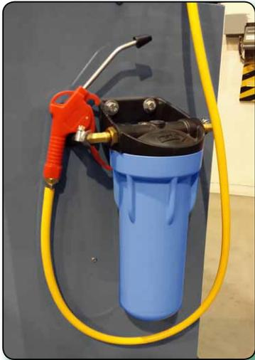
Le système de filtration en ligne optionnel « Blue Filter » améliore les performances de nettoyage du nettoyeur, augmente sa durée de vie, diminue son entretien et réduit les déchets en filtrant les particules solides.
