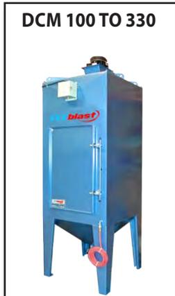
À l'intérieur du dépoussiéreur, un filtre sec contient un ensemble de tubes en satin de coton qui agissent comme système de filtration pour évacuer l'air propre à l'extérieur du cabinet. Périodiquement, les sacs filtrants doivent être secoués pour en déloger la poussière et la récolter dans un tiroir au fond du dépoussiéreur. Il suffit de vider le tiroir occasionnellement.
