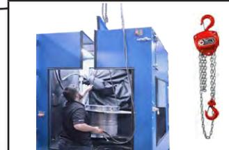
Fentes dans le plafond permettant le chargement / déchargement de pièces avec un palan à chaîne
