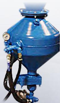
Tous les cabinets à pression ISTblast sont équipés d'un vaisseau sous pression de 1.3 pied cube muni d'une valve de dosage AR-7 pour en définir l'efficacité. Cette valve permet la mise au point de l'écoulement des médias au point de mélange où l'abrasif rencontre le flux d'air. La pressurisation / dépressurisation du vaisseau se fait automatiquement à partir de la pédale de contrôle au pied par le biais de la valve à air.
