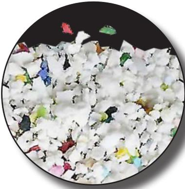
Le média de plastique est un abrasif qui ne produit pas de poussière et qui est obtenu à partir d'un polymère spécialement conçu pour procurer des propriétés accrues au niveau de sa résistance à la traction, sa compression et sa flexion, tout en ayant une dureté relativement basse. Il s'agit d'un média relativement doux sur les surfaces, mais très efficace pour nettoyer ou décaper la peinture, les revêtements ou autres résidus tenaces.
