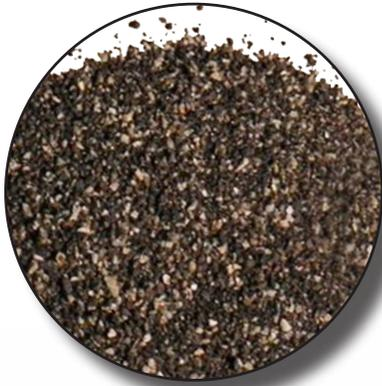
L'oxyde d'aluminium est obtenu à partir de minerais de haute qualité et est chimiquement inerte. Il permet d'obtenir une abrasion extrêmement agressive et peut être réutilisé plusieurs fois.
