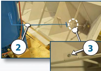
**NB :** Les vis hex. 3/8" (3) doivent être placées dans les trous tel que montré pour en éviter l'obstruction par le média de sablage et permettre le nettoyage des injecteurs à l'aide de la tige de nettoyage fournie (2).
