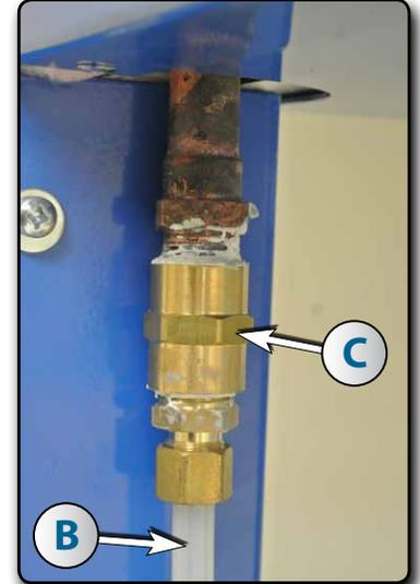
3. Enlever l'assemblage avec coude et bouchon et remplacer par le raccord (C) et y connecter le tube nylon blanc (B)
