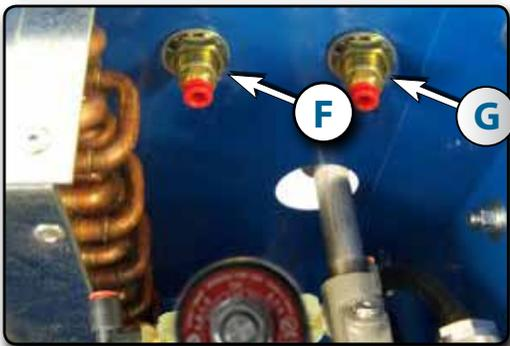
Ensuite installer les 2 raccords de cloison **F** et **G** . Note: celui pour le régulateur (324503) va sur le côté gauche.
