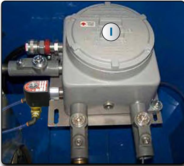
9. Installer les 2 raccords "push in" f **E** sur la valve solénoïde.
