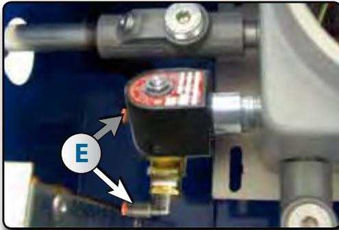
6. Installer les 2 raccords "push in" **E** sur la valve solénoïde.
