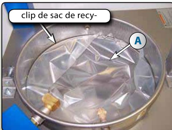
1. Avant de remplir le recycleur, placer un nouveau sac de recyclage (A) dans la bouilloire. Assurez-vous que le clip est fermement en place dans la rainure de la cuve et replier la partie du sac en excès vers le bas sur le clip.
