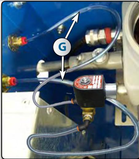
7. Installer le tube bleu **G** depuis le raccord "push in" de cloison du régulateur de pression à l'entrée d'air de la valve solénoïde puis installer l'autre tube entre la sortie de la valve solénoïde et l'autre extrémité au raccord "push in" du vacuum tel que montré
