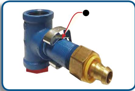
Le régulateur d'abrasif AR ¾ se situe au bas du cabinet (Page 9, n° 25). Veillez à ce que rien n'en obstrue l'orifice. Réglez l'ouverture de l'orifice• qui doit toujours se situer au-dessus, à environ 1/3 ouvert, grâce à la pince ajustable. Une plus petite ouverture amènera plus d'abrasif au pistolet, une plus grande moins d'abrasif. Une ouverture une fermeture complète empêchera l'arrivée de l'abrasif.
