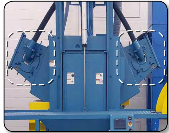
Deux roues de projection VK PowerMax
