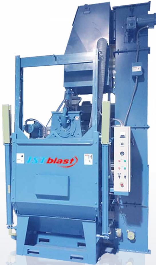
Avec l'accent mis sur un nettoyage rapide et économique par un système de sablage sans air par grenailage, les systèmes de sablage à panier rotatif ISTblast sont disponibles dans des capacités allant de 2,5 à 22 pieds cubes.
