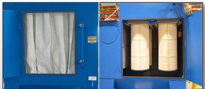
Dépoussiéreur standard avec sac à poussière pouvant capter 99,5% des particules étrangères jusqu'à 3 µm.
