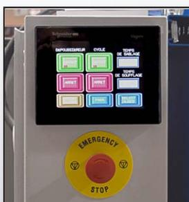
Le processus est entièrement contrôlé par un PLC et interfacé par un panneau HMI
