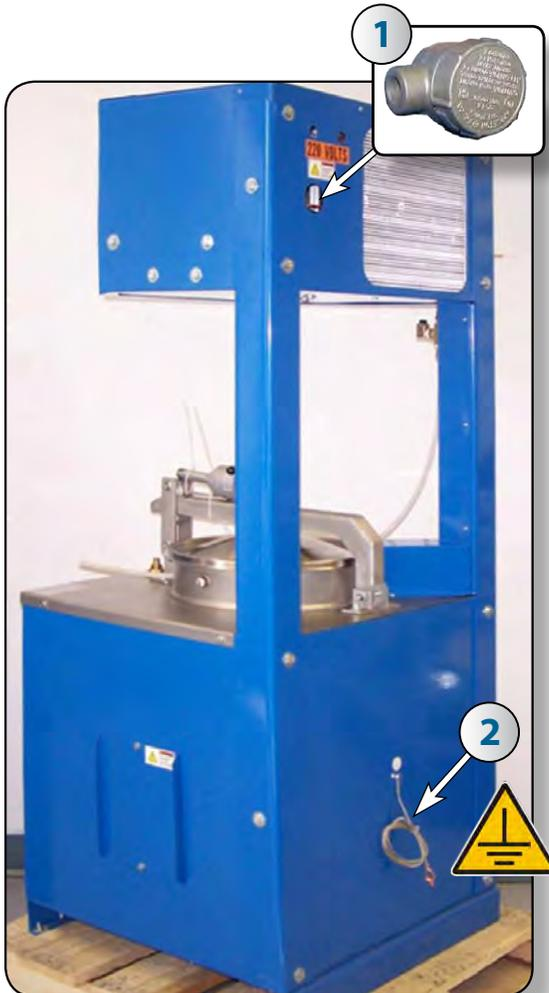
**Étape 5 :** Maintenant nous sommes prêts pour que l'électricien branche le recycleur de solvants. Pour le modèle **SR30** connecter à une alimentation **220 V / 1 ph.** dans la boîte de jonction électrique **1** qui est fournie à l'arrière de l'appareil. **Le recycleur 7.5 gallons nécessite un courant de 15 A**
