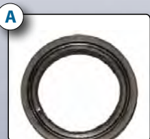
Montre un bord intérieur usé provoquant l'échec de l'étanchéité.
