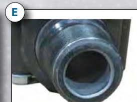
Le mamelon de la valve de dosage de 1½ ne montre que des signes minimes d'usure.
