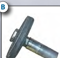
Seuls des signes minimes d'usure sont visibles sur le plongeur.
