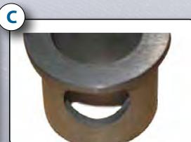
Seuls des signes minimes d'usure sont visibles sur la douille.
