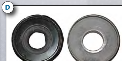
Le siège en uréthane (à gauche) est complètement intact avec une usure normale. La garniture en acier inoxydable (à droite) ne montre aucun signe d'usure.
