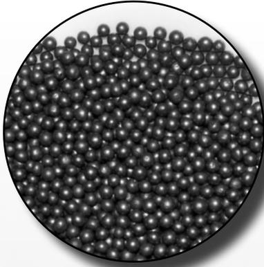
La bille d'acier (communément appelée SHOT) est une particule ronde et solide qui procure un fini martelé et une surface lisse. Dû à son poids, le SHOT produit un impact et une action de martèlement importante permettant de nettoyer les pièces forgées et d'éliminer la calamine causée par le traitement.
