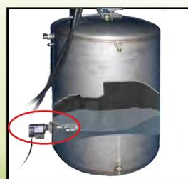
Le capteur de débordement offre une protection supplémentaire pour les réservoirs de vacuum au cas où l'opérateur oublie de le vider avant d'entamer un nouveau processus. Cet interrupteur empêche la pompe de transférer le solvant sale dans la bouilloire jusqu'à ce que le réservoir de vacuum ait été vidé. Le capteur est soutenu par des temporisateurs de séquence de remplissage dans le logiciel et permet à l'opérateur de savoir que la bouilloire ne s'est pas remplie.
