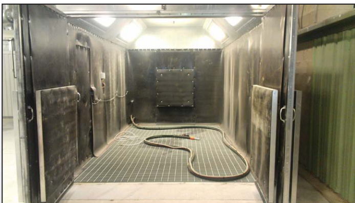
Plancher de récupération complet
