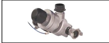
La valve de régulation d'abrasif PMV-186 est conçue pour couper l'écoulement de l'abrasif à la soupape de dosage, devant le port de mélange, et éliminer les délaïs et abrasifs souvent résiduels dans une valve de dosage normalement ouverte.
