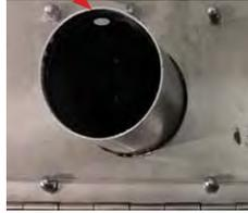
1. Fixez la cheminée d'extraction sur le dessus de la laveuse en utilisant le matériel fourni et le joint d'étanchéité (**Img.1**).
