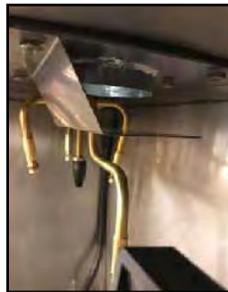
À l'intérieur de la laveuse, installez le joint en néoprène entre l'extracteur et le réservoir et installez le déflecteur en dernier.
