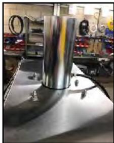
Monter l'extracteur tel qu'indiqué sur cette image, avec les écrous borgnes et les rondelles frein sur le dessus de la laveuse.
