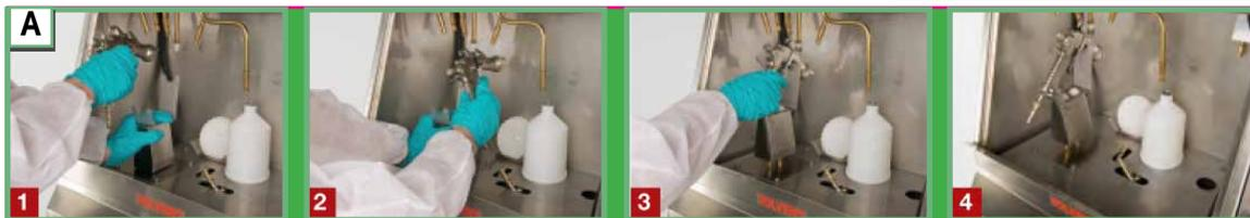
1 Abaisser le support 2 Positionner le pistolet 3 Relâchez le support pour mettre le pistolet en position 4 Démarrer le processus de lavage automatique
