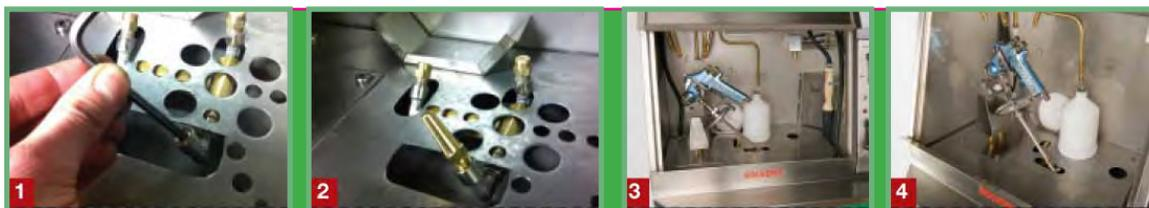
1 Enlevez le bouchon de buse 2 Placez la buse (fournie) dans le raccord de buse 3 Positionner le pistolet à aspiration tel que montré 4 Démarrer le processus de lavage automatique
