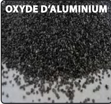
Utilisé principalement pour coupage par abrasion. Produit d'excellents ancrages en préparation pour le recouvrement.
