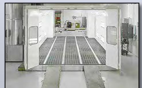
Installation sur plancher surélevé
