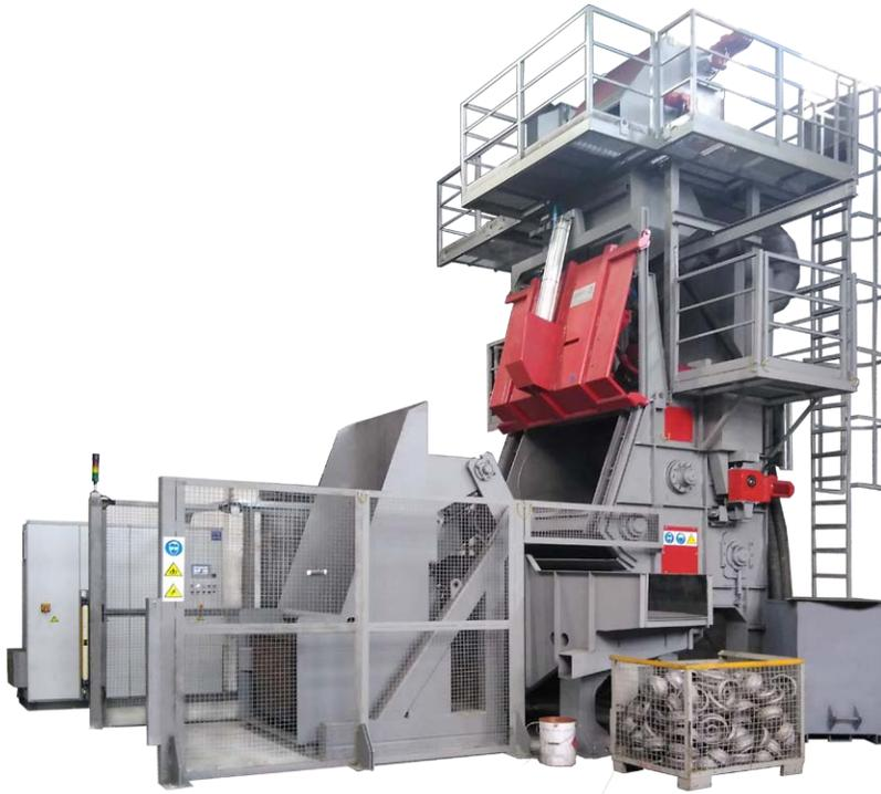
Les machines sont dotées d'une chenille sans fin faite de bandes en acier. Les objets traités sont placés sur la chenille par une procédé de remplissage spécial. Lorsque la chenille se déplace, sa forme spéciale fait que les objets traités s'inclinent et roulent, ce qui permet d'avoir un jet d'abrasif de qualité sur toute la surface des objets traités. Pour le vidage, la chenille est mise en marche en mode de rotation en sens inverse.
