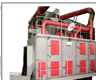
PNB - Grenailleuse à tambour oscillant pour pièces coulées
