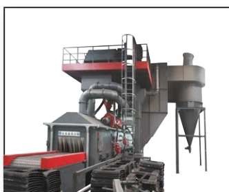
KTP - Grenailleuse à convoyeur en bande maillée
