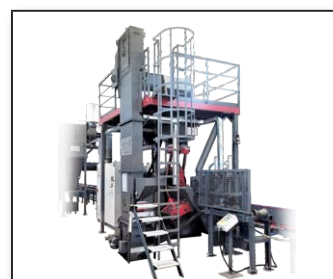
PC - Grenailleuses avec convoyeur à rouleaux
