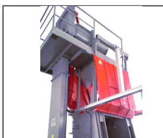
GG - Grenailleuse par culbutage avec bande en caoutchouc
