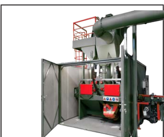
PL - Grenailleuse pour barres d'acier plat
