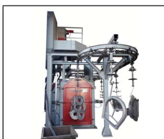
VKP - Grenailleuse à convoyeur de pièces en continu
