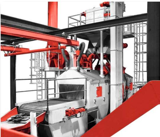
Les objets traités sont placés sur un convoyeur à réseau horizontal passant par la grenailluse. Dans le processus de grenaillage, les objets traités se déplacent à travers des jets d'agent de grenaillage provenant de turbines, qui sont installés à des angles différents par rapport à la direction du mouvement, ce qui fournit un traitement efficace.
