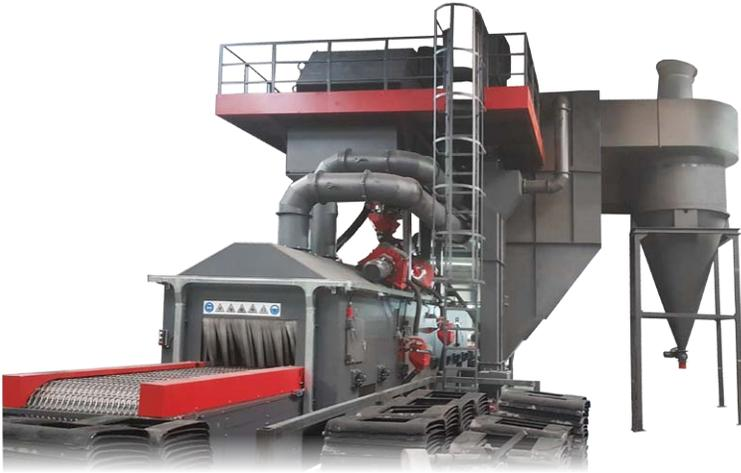
Élimination des restes de sable de coulée et des noyaux, élimination de la rouille, élimination de l'ancienne peinture, élimination des signes visibles de soudage et de découpe noble, élimination de la couche oxydée causée par le traitement thermique, etc.
