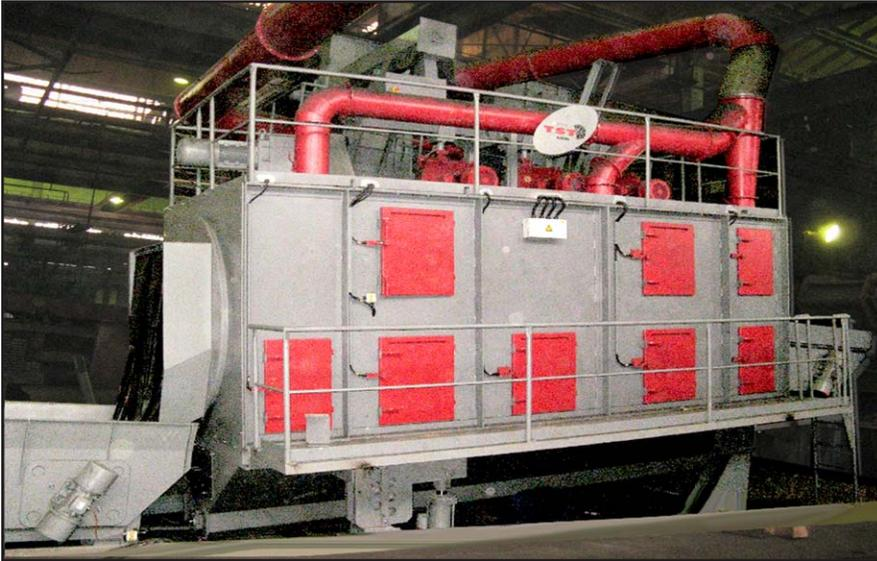
Elle est utilisée pour le grenailage de pièces de différentes formes et de poids allant jusqu'à 220 lb et des séries plus importantes, qui sont adaptées à un flux continu à travers la grenailleuse.
