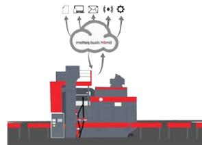
La plateforme « Sm@rt Cloud » vous permet de contrôler et d'optimiser les performances de la grenailleuse, du dépoussiéreur et de la roue de grenailage.
