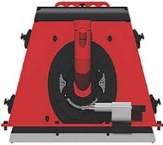
Dans les machines où les roues sablent différents types de pièces dont les dimensions sont très différentes, il est possible d'équiper la roue d'un module avec cage de contrôle rotatif.
