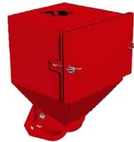
Le filtre est équipé d'une grille en acier qui protège la roue contre l'entrée de pièces susceptibles de l'endommager. Le filtre est monté entre la vanne d'alimentation et le tuyau d'entrée. L'entretien du filtre est très facile. Il suffit de retirer le couvercle avant et d'enlever les grosses particules.
