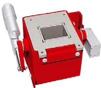
La valve de régulation du débit d'abrasif permet de contrôler un débit constant d'abrasif (sans hystérésis). La vanne de base a une course réglable manuellement de 0 % à 100 %. En cas d'interruption de l'alimentation électrique ou de l'air comprimé, la valve se ferme automatiquement. La version de base de la valve peut être complétée par un module automatique pour contrôler le flux d'abrasif.
