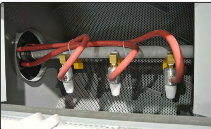
Buses de sablage latérales oscillantes
