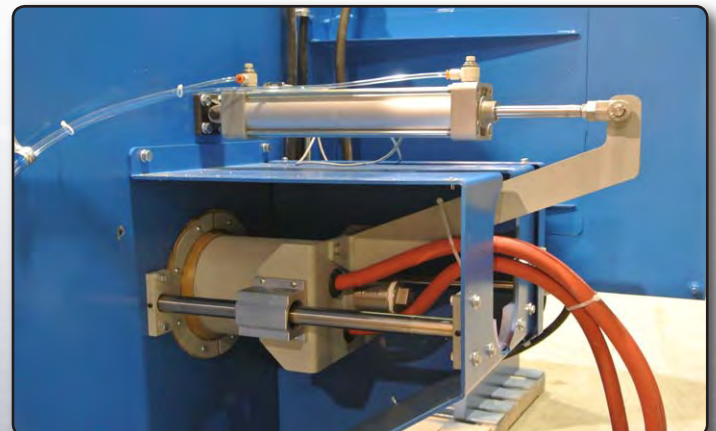
Vérin pneumatique pour axe des pistolets de sablage
