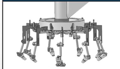
Disponible avec 6, 9 ou 11 buses, la tête rotative permet de contrôler la vitesse de rotation, la durée d'exposition au flux d'abrasif ainsi que la direction des buses afin d'obtenir un traitement uniforme sur les pièces de travail.
