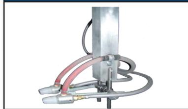
Le support de buses fixe avec bras ajustable libère les mains de l'opérateur lors du sablage des pièces ou peut être synchronisé avec une table rotative motorisée afin d'obtenir un procédé de traitement semi-automatisé.
