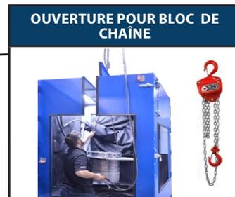
Fentes dans le plafond permettant le chargement / déchargement de pièces avec un palan à chaîne
