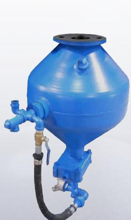
Tous les cabinets à pression ISTblast sont équipés d'un vaisseau sous pression de 1.3 pied cube muni d'une valve de dosage AR-7 pour en définir l'efficacité. Cette valve permet la mise au point de l'écoulement des médias au point de mélange où l'abrasif rencontre le flux d'air. La pressurisation / dépressurisation du vaisseau se fait automatiquement à partir de la pédale de contrôle au pied par le biais de la valve à air.
