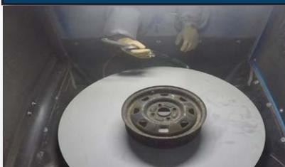
Standard avec vitesse ajustable et capacité de charge jusqu'à 500 lb, les tables rotatives motorisées permettent de faciliter la manipulation des pièces durant le sablage manuel ou peuvent être synchronisées avec un support de buse fixe ou une tête de sablage rotative afin d'obtenir un procédé de sablage semi-automatisé.
