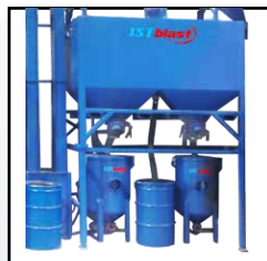
Silo double & Vaisseaux sous pression
