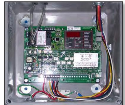
Nettoyeur automatique de cartouche par impulsion. Une lumière s'allume pour indiquer quand les cartouches doivent être remplacées.
