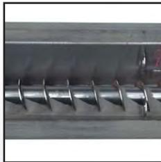
Système de récupération par convoyeur à vis
