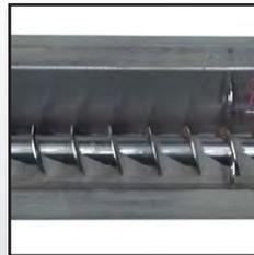
Système de récupération par convoyeur à vis et trémie de récupération
