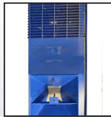
Système de récupération pneumatique avec trémie au plancher
