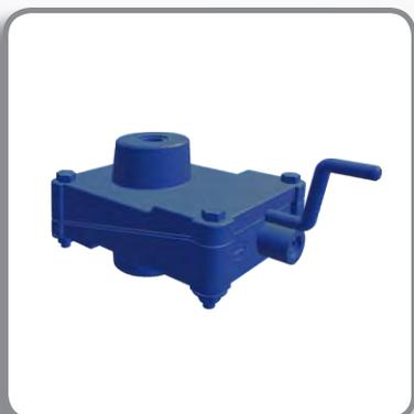
Le régulateur d'abrasif AR7 est situé au bas du vaisseau sous pression. Il doit être réglé en fonction du type d'abrasif utilisé. Tourner la poignée d'env. 1/4 de tour dans le sens horaire à la fois pour diminuer la quantité d'abrasif à la buse et dans le sens antihoraire pour l'augmenter. Vous devez attendre 15 secondes avant que tout changement puisse être remarqué. L'ajustement pour diminuer la quantité doit être effectué pendant que le vaisseau sous pression est en fonctionnement.
