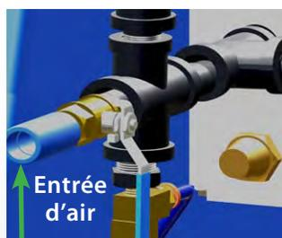
Connectez le boyau d'alimentation en air de votre atelier à l'entrée d'air. Le boyau doit avoir un diamètre intérieur minimum de 1/2". N'utilisez jamais de raccords rapides mâle-femelle. **Choisissez des raccords qui limitent le moins possible le débit d'air.**
